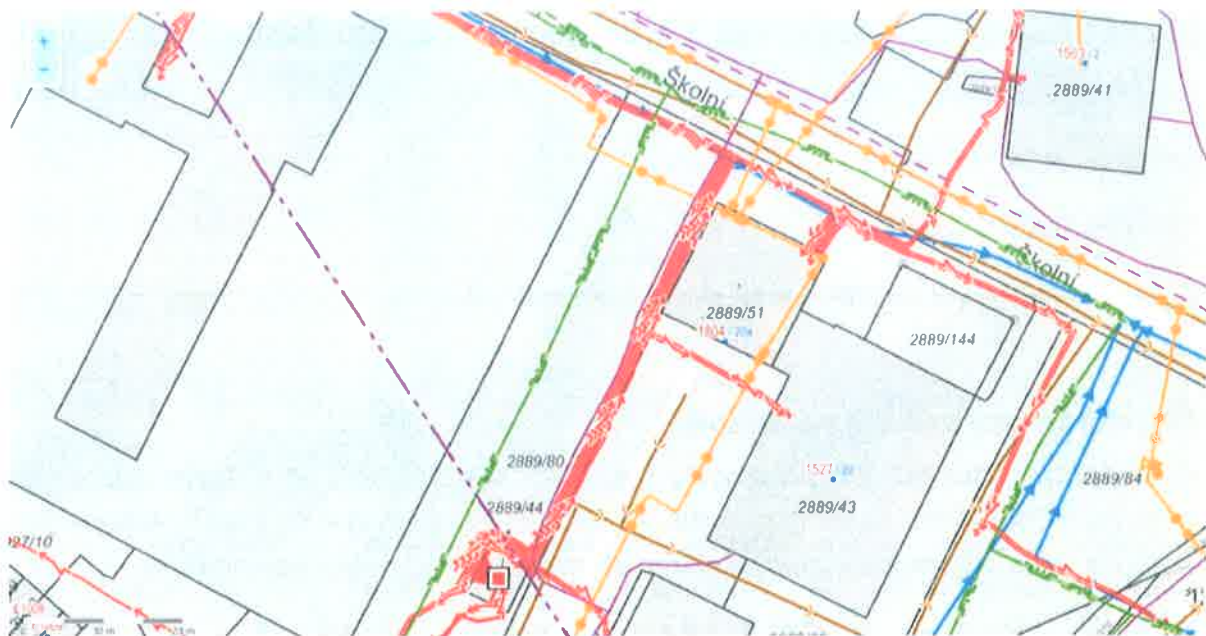
Obrázek 1 – Orientační zakres technické infrastruktury: červeně – elektro, včetně TS, žlutě – teplovod, modře – vodovod, fialově – telekomunikační vedení, zeleně – plynovod.
