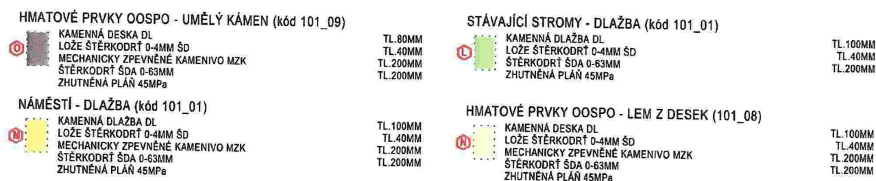
Obrázek 5 – Požadované skladby dlažby tl. 100 mm
